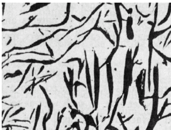
Диаграмма 9. Структура серого чугуна и высокопрочного чугуна с шаровидной формой графита
